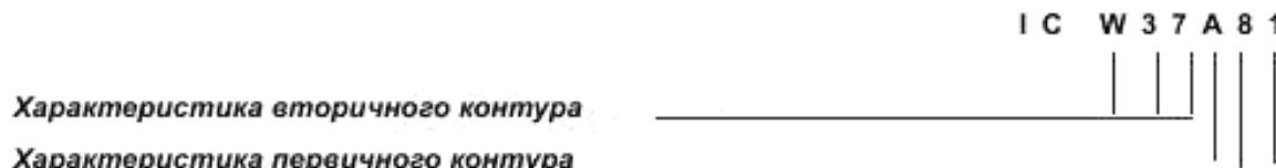
В этом издании стандарта предусмотрено по возможности упрощенное обозначение путем пропуска в обозначении буквы A и цифры 7 при определенных условиях перемещения вторичного хладагента.
