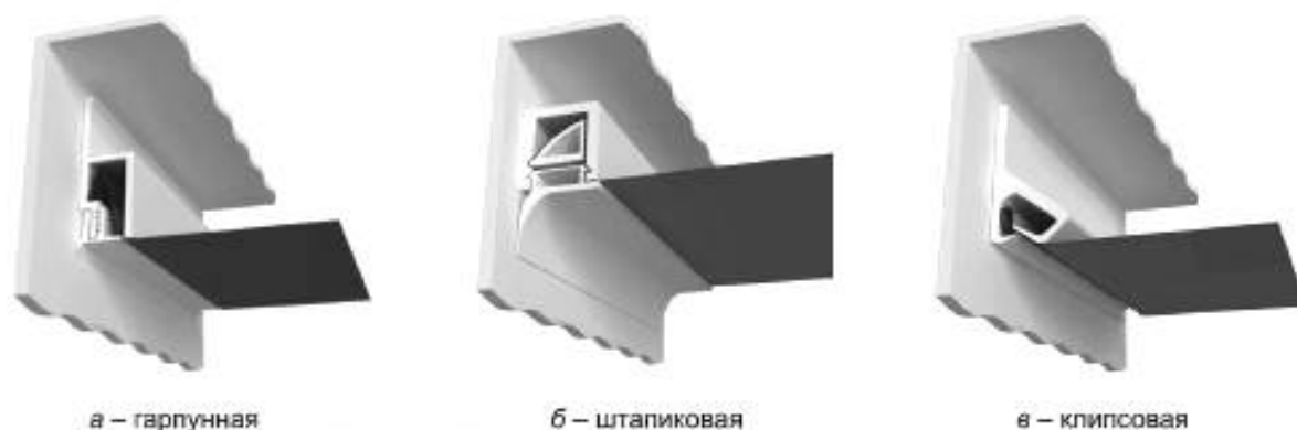
Рисунок 1 — Системы крепления полотна натяжного потолка
