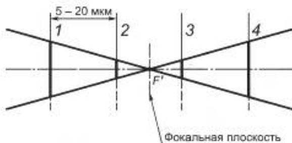
Рисунок 11 — Схема образования плоскостей фокусировки
