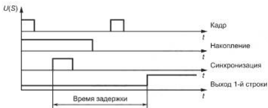
Рисунок 19 — Временная диаграмма для измерения времени задержки фотоотклика
