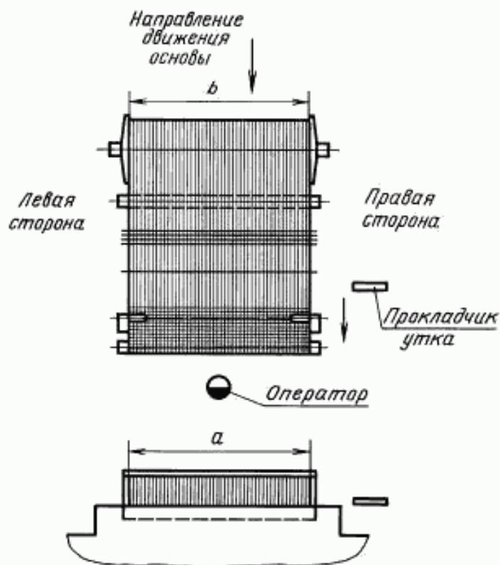
$a$  — рабочая ширина; максимально возможная ширина проборки основы по берду, включая кромки;  $b$  — максимальная ширина основы; расстояние между внутренними поверхностями фланцев ткацкого навоя
