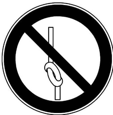
Рисунок 2 — Пример знака о запрещении завязывать канаты узлом
