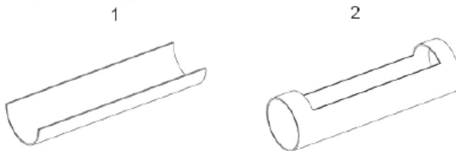
1 – образец со срезанной верхней частью; 2 – образец с вырезанным фрагментом
