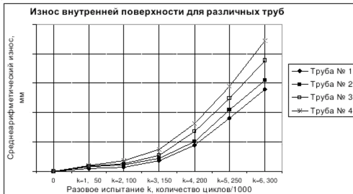
Рисунок 4 – Зависимость износа от количества испытательных циклов
