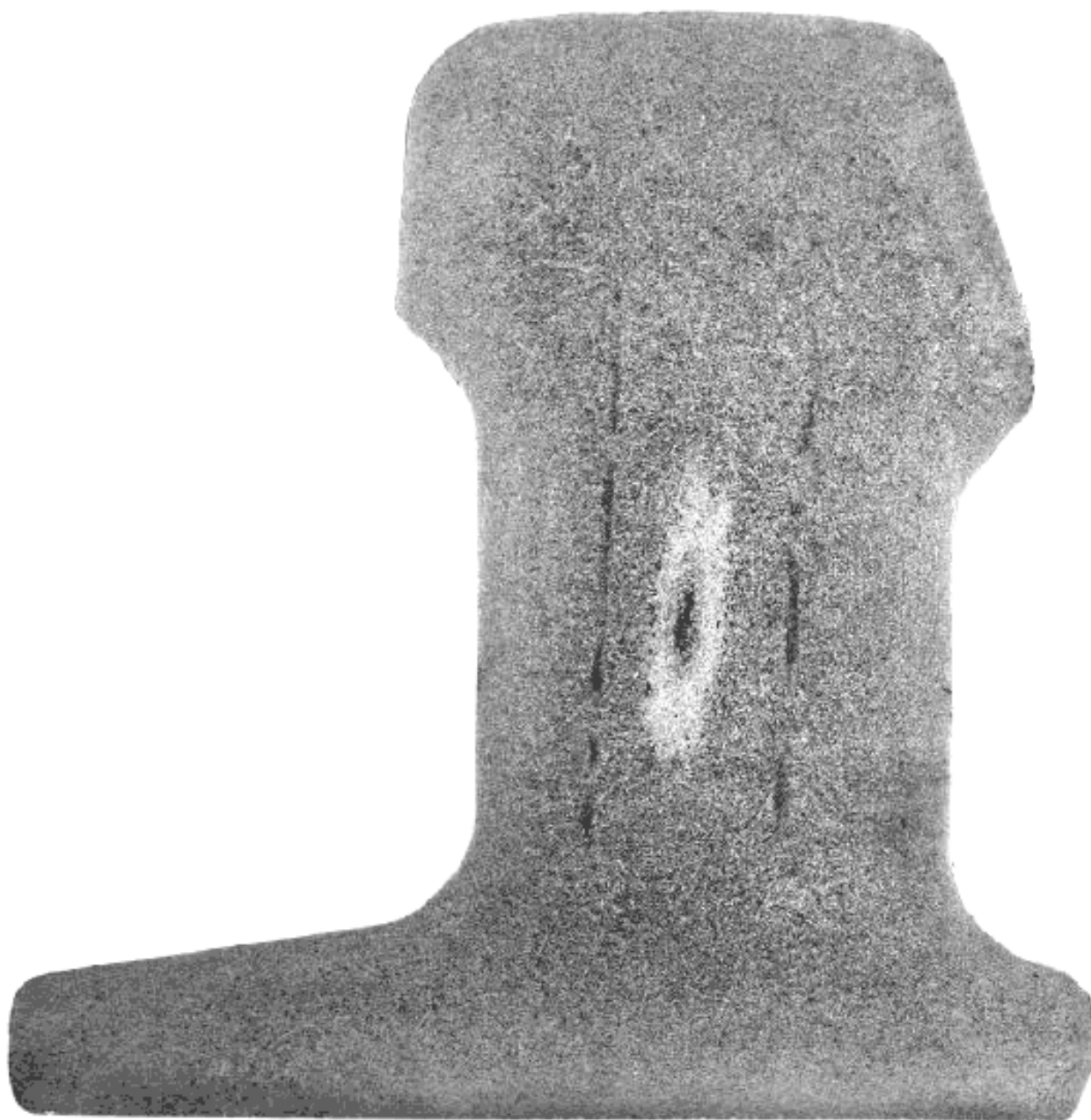
Рисунок Ж.2 — Осевая ликвация
