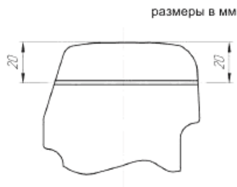
Рисунок В.5 — Расположение бокового сквозного цилиндрического отверстия в головке меры
