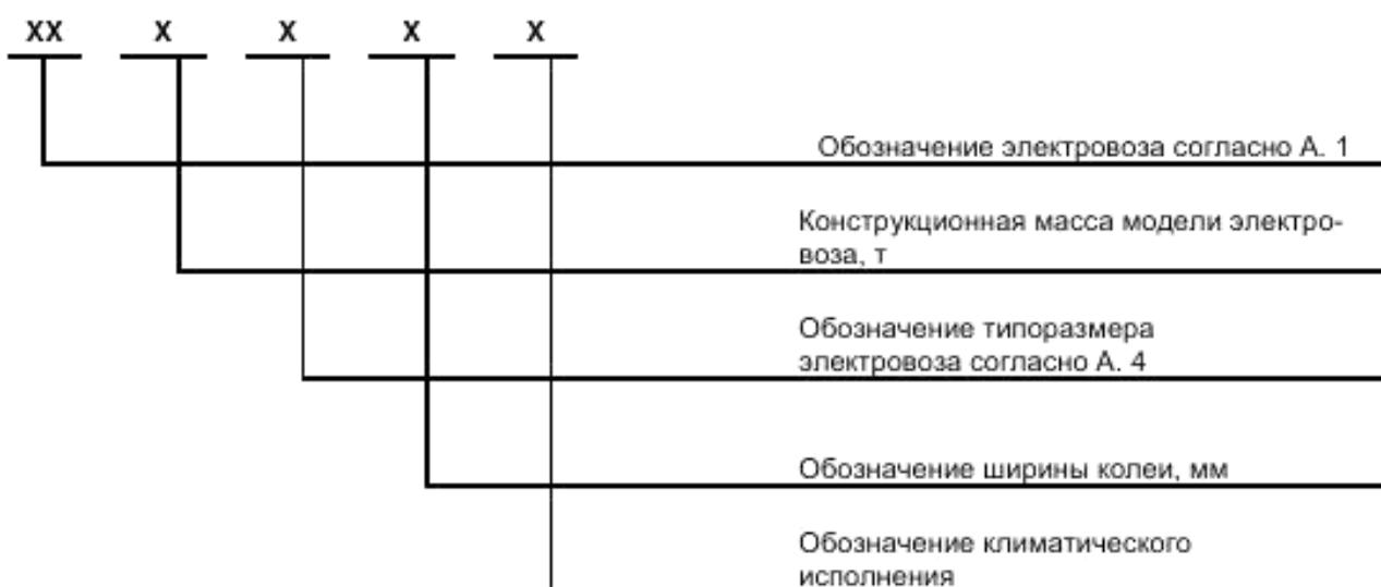
А. 7 Пример условного обозначения модели электровоза рудничного аккумуляторного взрывобезопасного массой 10 т, 2-го типоразмера по сцеплению, на колею шириной 900 мм, в климатическом исполнении Т: АРВ10-2-900-Т-ТУ...
