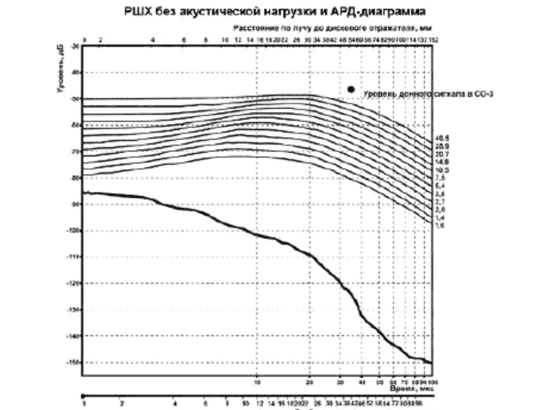
За уровень 0 дБ принятая амплитуда импульса возбуждения преобразователя (20 В). Разметка времени по горизонтальной оси соответствует распространению сигнала только в материале объекта контроля. Справа от кривых АРД указана площадь соответствующего дискового отражателя в квадратных миллиметрах.
