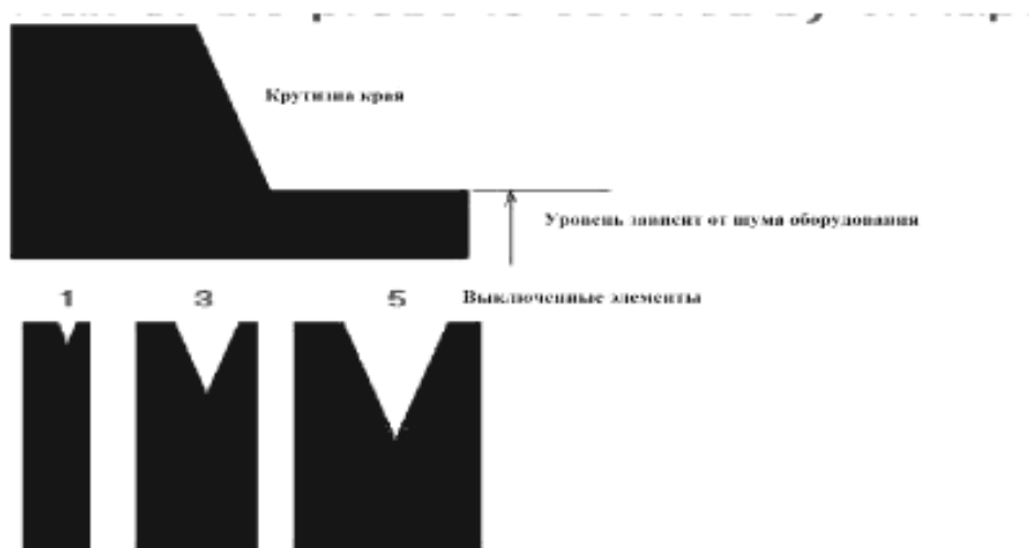
Рисунок D.4 – Интерпретация имитации неисправности датчика, когда его половина покрыта пятью слоями 50-миллиметровой матерчатой ленты
