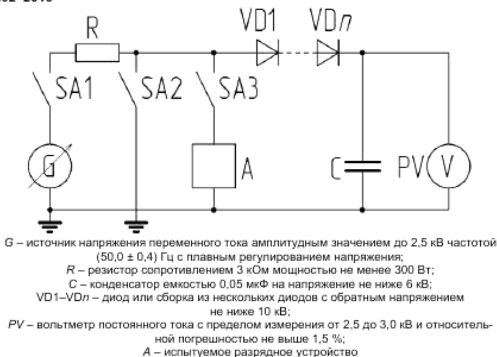
Рисунок 1 – Схема для проверки напряжения срабатывания разрядного устройства
