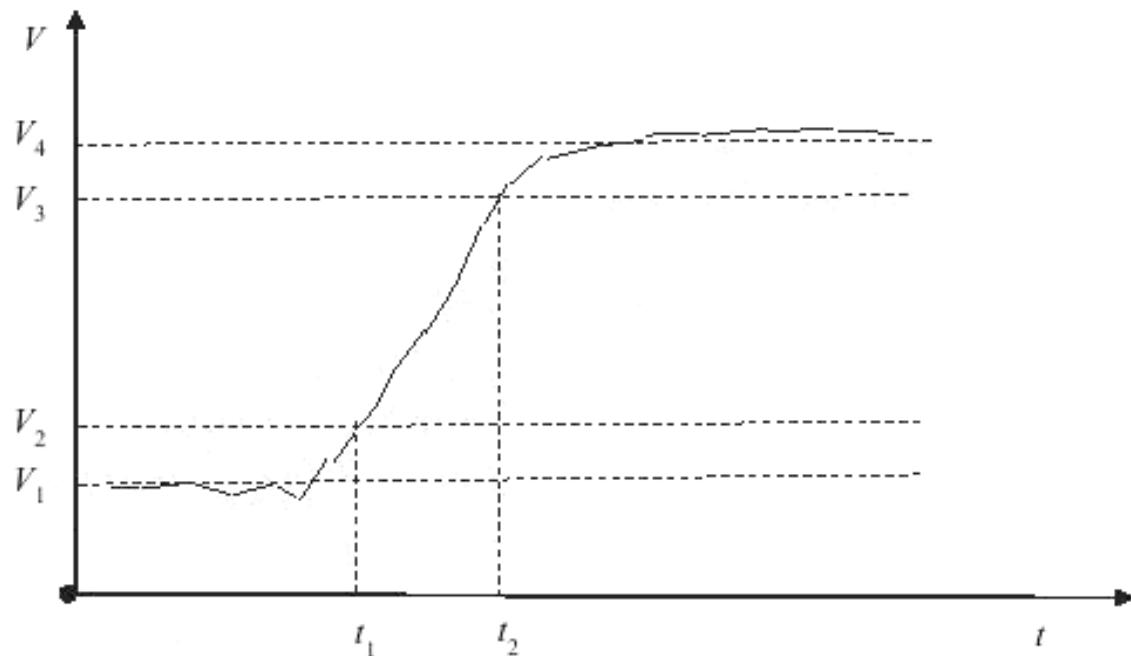
$V$  — выходной сигнал детектора;  $t$  — время;  $V_1$  — первоначальное установившееся значение выходного сигнала;  $V_4$  — новое установившееся значение выходного сигнала;  $V_2 - V_1 = V_4 - V_3 = 0,1$  ( $V_4 - V_1$ )
