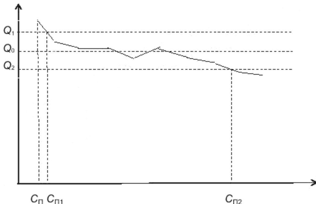
$Q_0$  — уровень линейного диапазона;  $Q_1 = 1,05Q_0$ ;  $Q_2 = 0,95Q_0$ ;  $C_p$  — концентрация, соответствующая пределу детектирования;  $C_{p1}$  — концентрация, соответствующая нижнему пределу линейного диапазона;  $C_{p2}$  — концентрация, соответствующая верхнему пределу линейного диапазона
