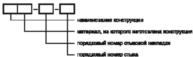
Рисунок А.3 — Условное обозначение стыковых накладок
