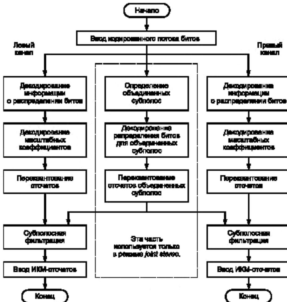
Рисунок Ж.2 — Общая блок-схема декодера стерео
