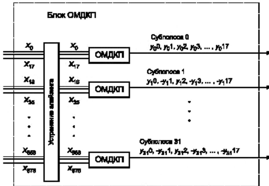
В каждом блоке ОМДКП вычисляются 18 выходных значений  $y_0 \dots y_{17}$  по 18 входным значениям спектральных коэффициентов. Для всех субполос, кроме первой, каждый нечетный выходной отсчет должен быть умножен на минус 1.
