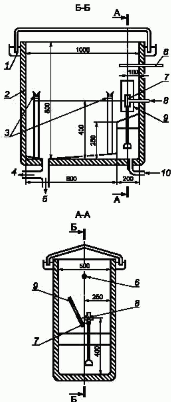
1 — гидрозатвор; 2 — нагревающая теплоизоляционная стенка; 3 — сборники (воронка площадью 80 см<sup>2</sup>); 4 — отвод воздуха; 5 — отвод воды; 6 — термометр; 7 — отверстие распылителя (сопло); 8 — подвод сжатого воздуха; 9 — дефлектор с регулируемым наклоном и расстоянием; 10 — подвод соляного раствора
