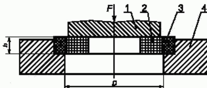
$F$  — сила; 1 — пуансон; 2 — изоляционное тело; 3 — защитная оболочка; 4 — упор (матрица)
