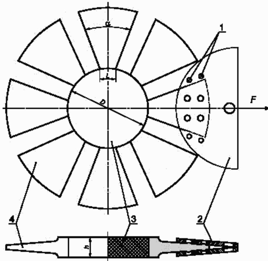
$L = 5 - 10 \text{ мм}$ ;  $h = (10 \pm 0,5) \text{ мм}$ ; для  $D \leq 80 \text{ мм}$   $h = 6 \text{ мм}$
