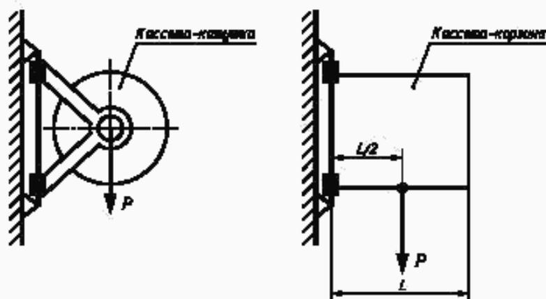
Рисунок 1 — Схема приложения нагрузки  $P$  к поворотной кассете
