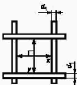
$d_1$  — номинальный диаметр проволоки;  $x$  — горизонтальное направление измерения размера ячейки;  $y$  — вертикальное направление измерения размера ячейки
