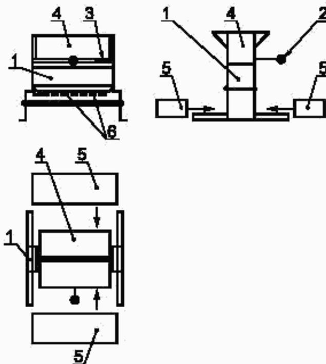
1 — основной корпус габаритными размерами  $(29,5 \pm 0,5) \times (28,0 \pm 0,5) \times (16,5 \pm 0,5)$  см; 2 — рукоятка; 3 — задвижка; 4 — бункер; 5 — поддон; 6 — лопасти размером  $(1,25 \pm 0,05)$  см
