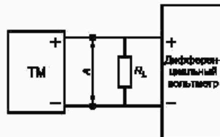
Рисунок 4 — Схема измерения выходного шума ТМ
