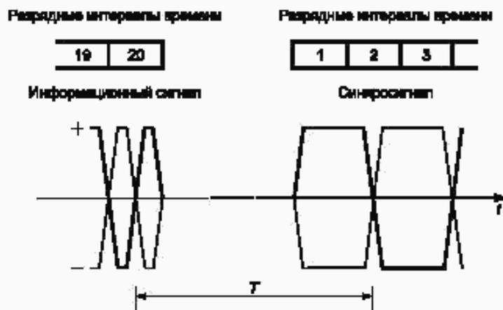
Рисунок 8 — Измерение времени паузы при передаче информации
