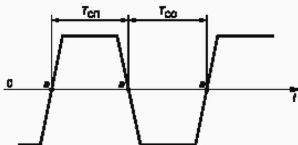
$T_{сп}$  — длительность положительной полуволны сигнала;  $T_{со}$  — длительность отрицательной полуволны сигнала; а — точка перехода сигнала через нулевой уровень (нуль — переход)
