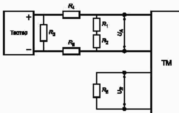
Рисунок 5 — Схема измерения взаимного влияния магистральных шин
