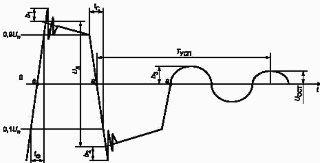
$t_0$  — длительность фронта сигнала;  $t_1$  — длительность спада сигнала;  $b_1, b_2, b_3$  — выбросы вершины сигнала и колебания его амплитуды;  $U_n$  — размах амплитуды;  $T_{усп}$  — время успокоения линии;  $U_{ост}$  — амплитуда остаточного напряжения; а — точка перехода сигнала через нулевой уровень (нуль — переход)
