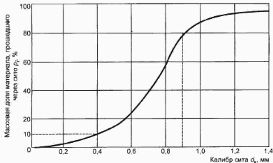
Рисунок А.1 — График ситового анализа материала
