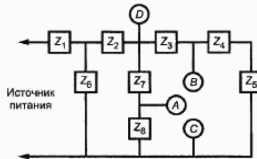
*D* — точка, максимально удаленная от источника питания, в которой максимальная рассеиваемая на внешней нагрузке мощность превышает 15 Вт. *A* и *B* — точки, ближайšie к источнику питания, в которых максимальная рассеиваемая на внешней нагрузке мощность не превышает 15 Вт; они являются маломощными точками
