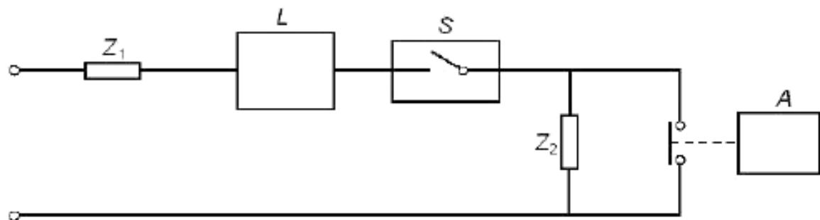
$Z_1$  — сопротивление для регулирования ожидаемого тока короткого замыкания (безиндуктивное);  $Z_2$  — сопротивление для регулирования тока нагрузки (безиндуктивное);  $L$  — ограничивающее устройство для величины  $I^2t$ ;  $S$  — испытуемый образец;  $A$  — вспомогательный выключатель для создания короткого замыкания.
