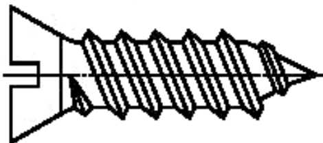
Рисунок 6 — Самонарезающий формующий винт
