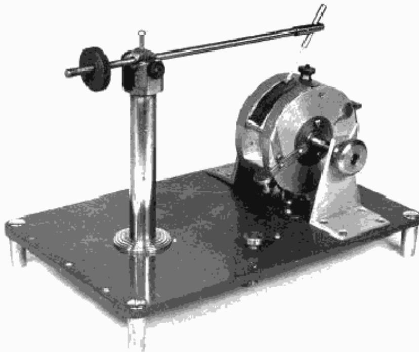
Рисунок 2 — Прибор для определения чувствительности спичек к воспламенению
