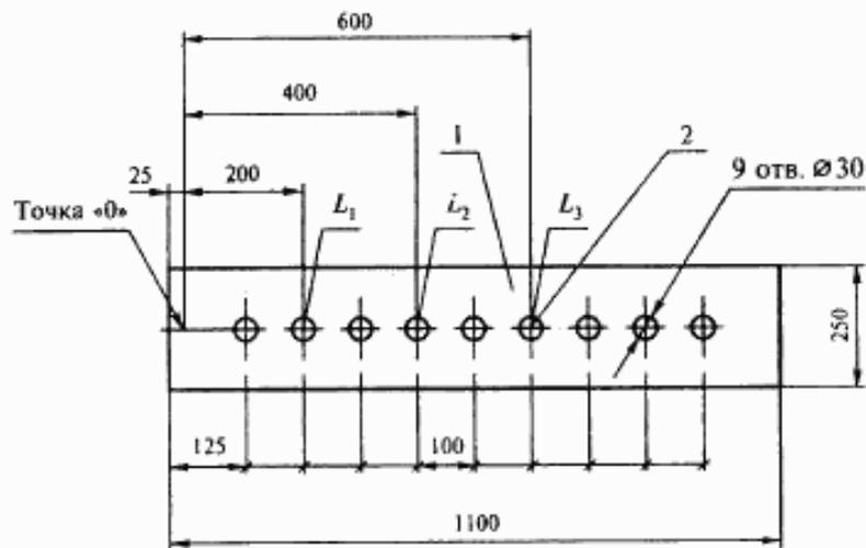
1 — калибровочный образец; 2 — отверстия для измерителя теплового потока
