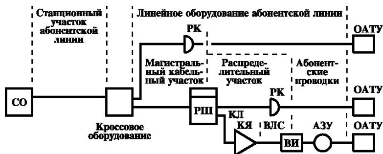
CO — станционное оборудование; ВЛС — воздушная линия связи; КЛ — кабельная линия; РШ — кабельный распределительный шкаф; РК — абонентская распределительная коробка; КЯ — телефонный кабельный ящик; ВИ — вводные изоляторы; АЗУ — абонентское защитное устройство; ОАТУ — оконечное абонентское телефонное устройство; | — место стыка
