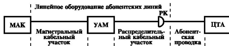
МАК — модуль абонентской концентрации; УАМ — удаленный абонентский модуль; ЦТА — цифровой телефонный аппарат; РК — абонентская распределительная коробка; — место стыка
