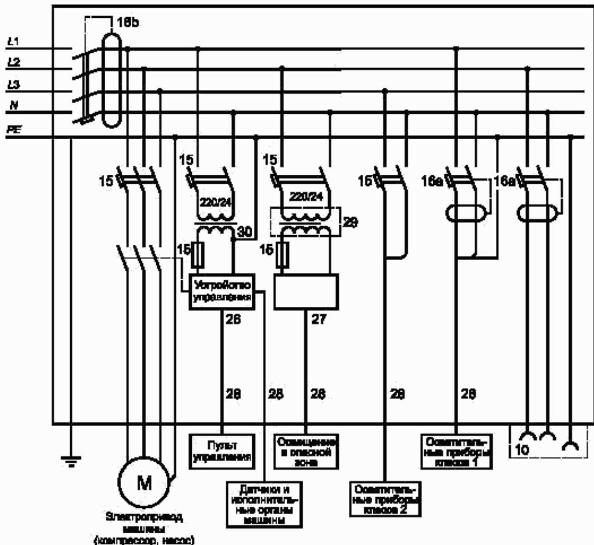
Рисунок А.4 — Пример подключения аттракциона к стационарной сети с системой заземления TN-S
