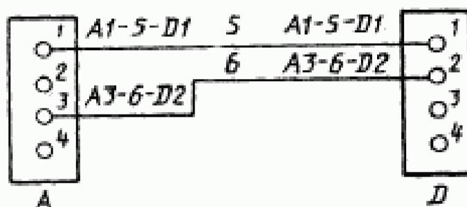
Черт. 7. Пример сложной маркировки для двух проводов
