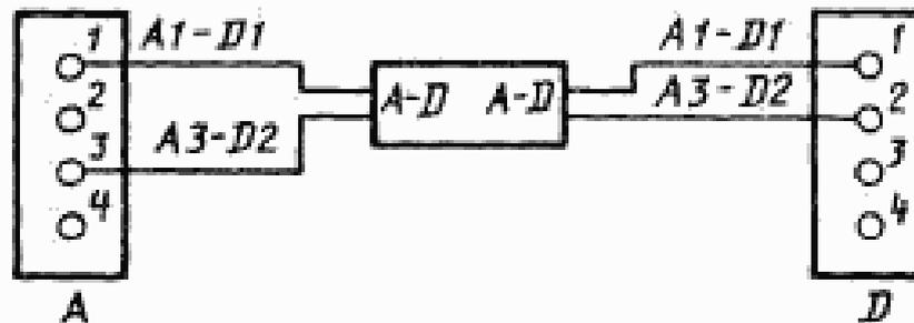
Черт. 2. Пример зависимой двойной маркировки для двух проводов и группы проводов (кабеля)
