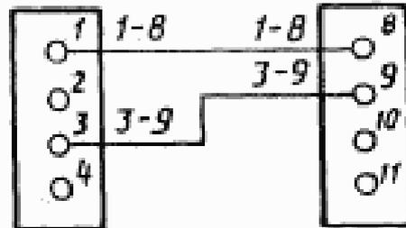
Черт. 1. Пример зависимой двойной маркировки для двух проводов
