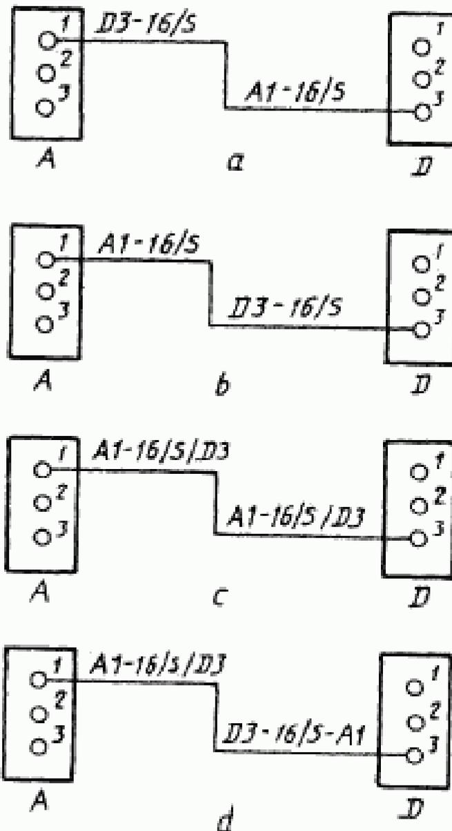
*a* — зависимая адресная маркировка; *b* — зависимая местная маркировка; *c* — зависимая двойная маркировка (идентичная маркировка на обоих концах); *d* — зависимая двойная маркировка (различная маркировка на каждом конце)
