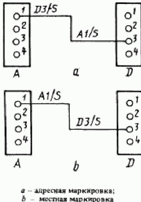
Черт. 11. Примеры зависимой маркировки с дополнительной маркировкой
