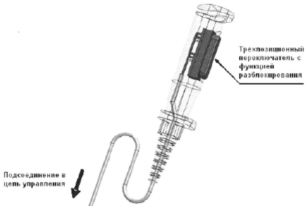
Рисунок А.1 – Устройство разблокирования
