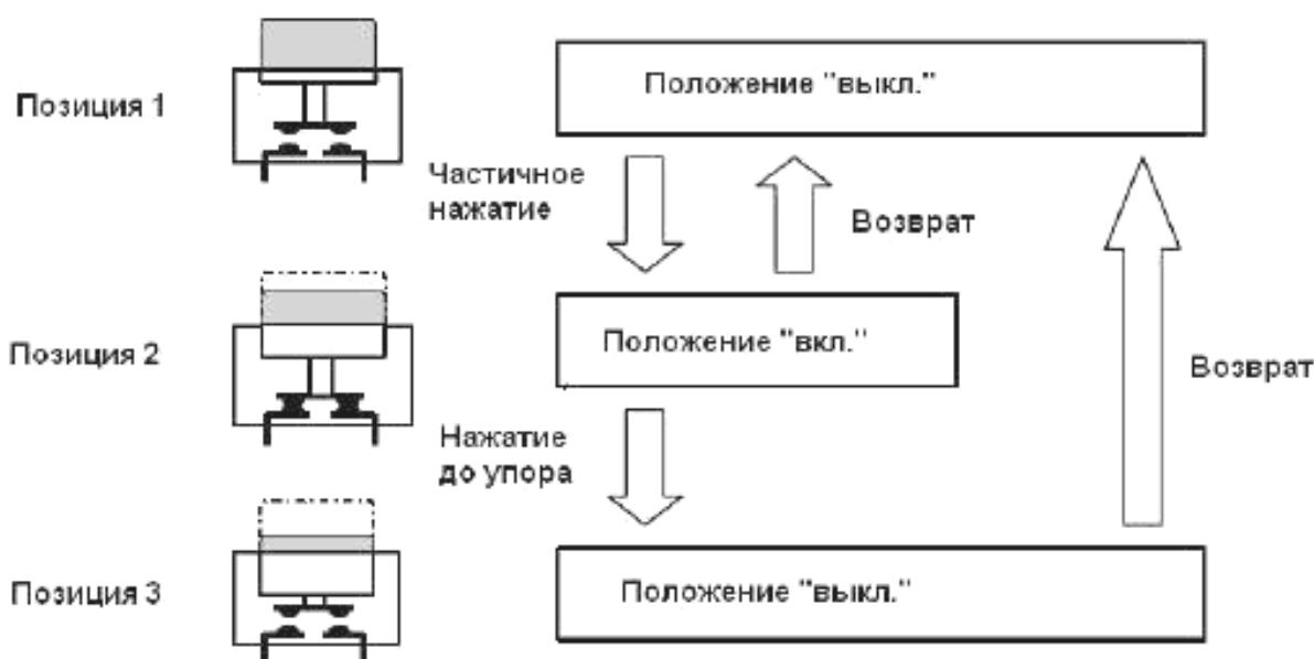
Рисунок 1 – Управление трехпозиционным переключателем с функцией разблокирования
