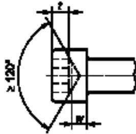
Для прокатных углублений наибольший предельный размер расширения в результате сверления не должен превышать 1/3 длины любой грани углубления, равной  $a/2$
