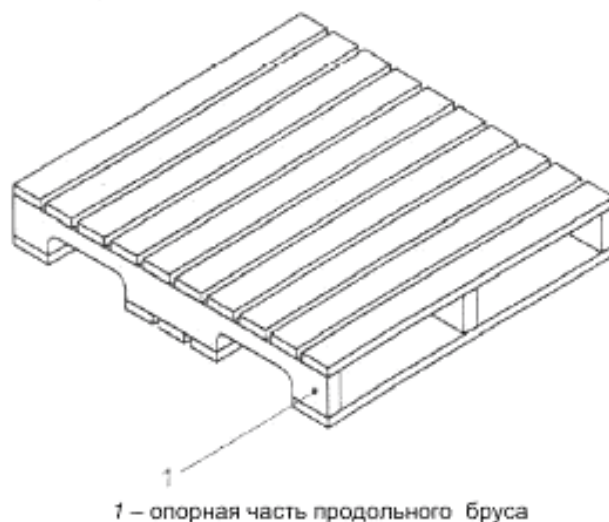
Рисунок 53 – Опорная часть продольного бруса
