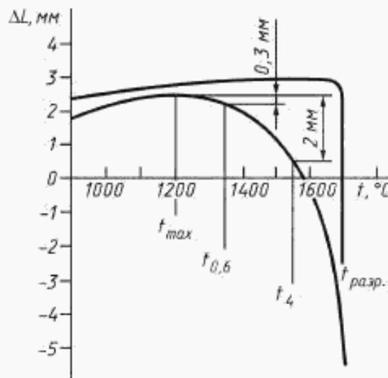
Рисунок 1 — Диаграмма «температура — деформация»
