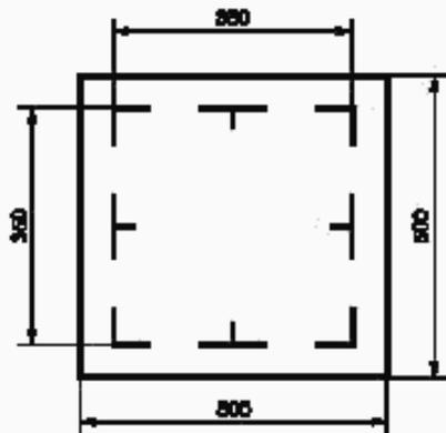
Рисунок 1 — Схема нанесения меток
