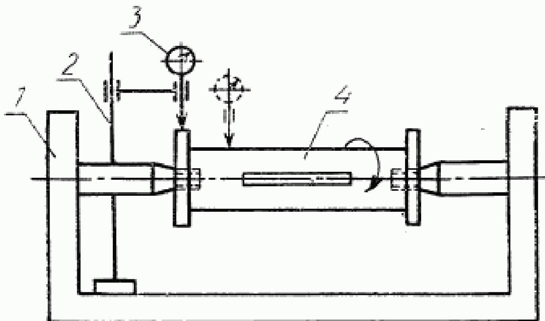
1 — прибор ПБ 250 или ПБ 500 М; 2 — стойка прибора; 3 — индикатор ИЧ 02; 4 — катушка
