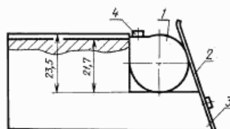
1 — кассета; 2 — пружина; 3 — приспособление; 4 — уплотнительная прокладка
