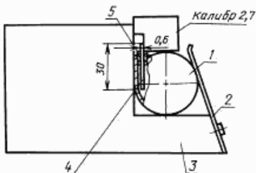
1 — кассета; 2 — пружина; 3 — приспособление; 4 — контрольная пластина; 5 — уплотнительная прокладка
