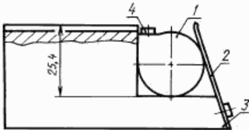
1 — кассета; 2 — пружина; 3 — приспособление; 4 — уплотнительная прокладка
