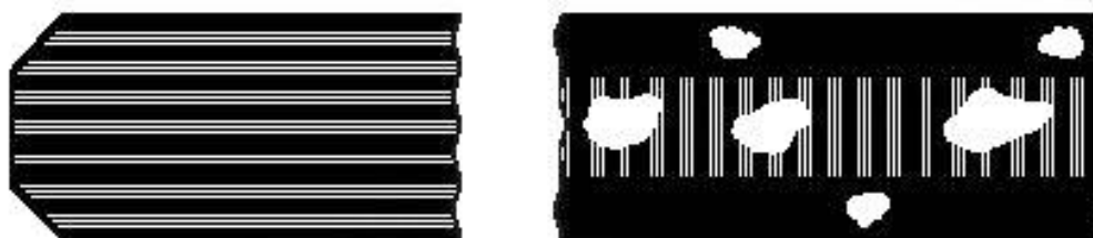
Рисунок А.2 — Грубо шлифованная кромка
