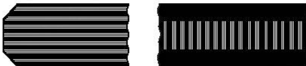
Рисунок А.3 — Гладко шлифованная кромка
