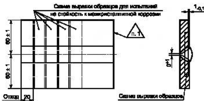
Рисунок В.12 — Контрольное сварное соединение
