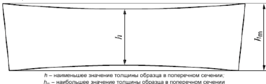
Рисунок 8 – Поперечное сечение образцов, полученных литьем под давлением
