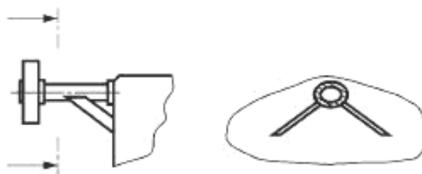
Рисунок 20 — Типовая конструкция ребер жесткости
