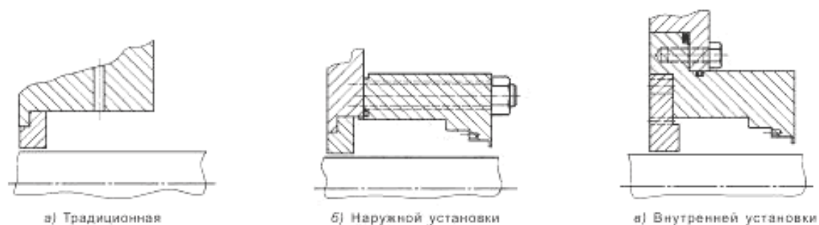
Рисунок 12 — Типы камер уплотнения
