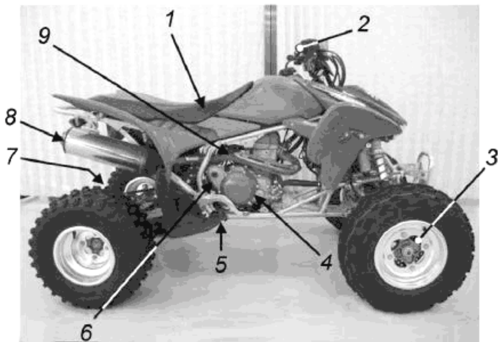
1 — сиденье; 2 — руль и рукоятки; 3 — дисковый тормоз; 4 — двигатель; 5 — площадка для ног; 6 — ножной рычаг запуска двигателя (кик-стартер); 7 — дисковый тормоз; 8 — выхлопная труба; 9 — рычаг воздушной заслонки, ручной орган управления для отключения топливоподачи.
