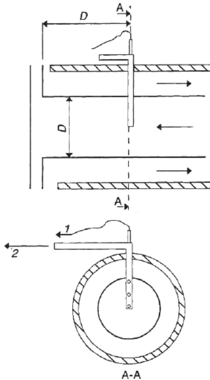
1 – к индикатору температуры; 2 – к насосу для отбора проб;  $D$  – диаметр канала
