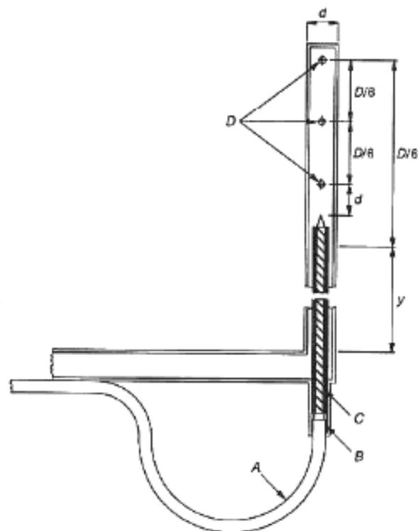
*A* – провод хромо-алюминиевой термопары; *B* – изолирующий материал; *C* – керамическая втулка с двойным отверстием; *D* – три отверстия для отбора проб  $\varnothing X$  мм
