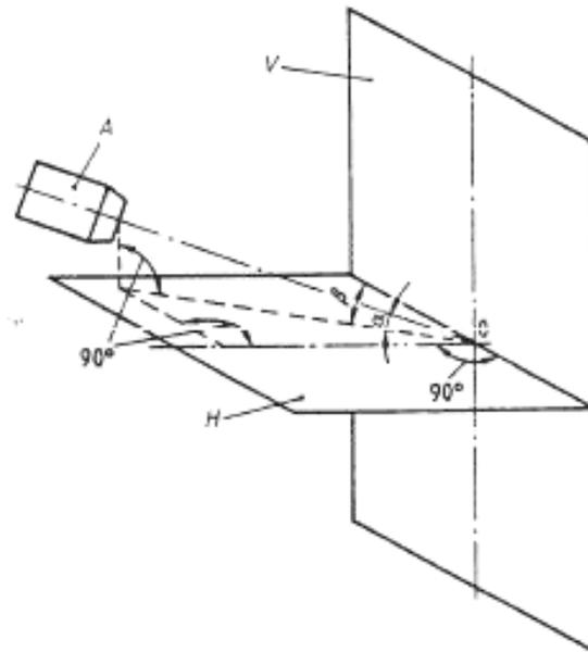
$A$  – вентилятор;  $H$  – горизонтальная плоскость;  $V$  – вертикальная плоскость;  $\alpha = 0^\circ$  (горизонтальный воздушный поток), плюс  $30^\circ$  и минус  $30^\circ$ ;  $\beta = 0^\circ$  (отраженный воздушный поток),  $15^\circ$ ,  $30^\circ$ ,  $45^\circ$ ,  $60^\circ$ ,  $75^\circ$ ,  $90^\circ$  (перпендикулярно к испытательной стенке)
