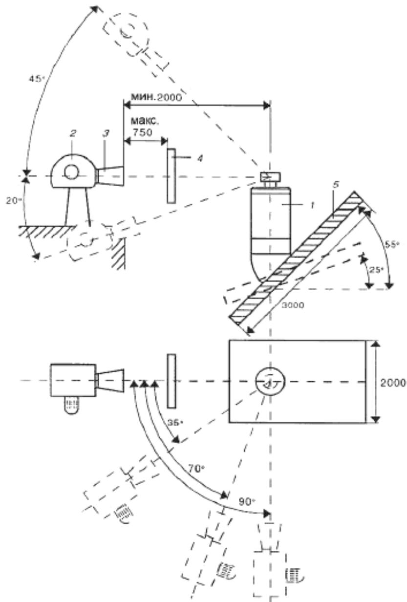
1 – оголовок аппарата (для подачи воздуха для горения и отвода продуктов сгорания); 2 – вентилятор (должен обеспечить установленные скорости воздуха по всему фронту воздушного потока с точностью  $\pm 10\%$ ); 3 – диффузор; 4 – фронтальная перегородка воздушного потока (должна быть такой, чтобы полностью перекрыть входное и выпускное отверстия оголовка аппарата); 5 – испытательная поверхность
