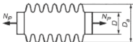
Рисунок 8.6 — Схема приложения распорных усилий в осевом компенсаторе
