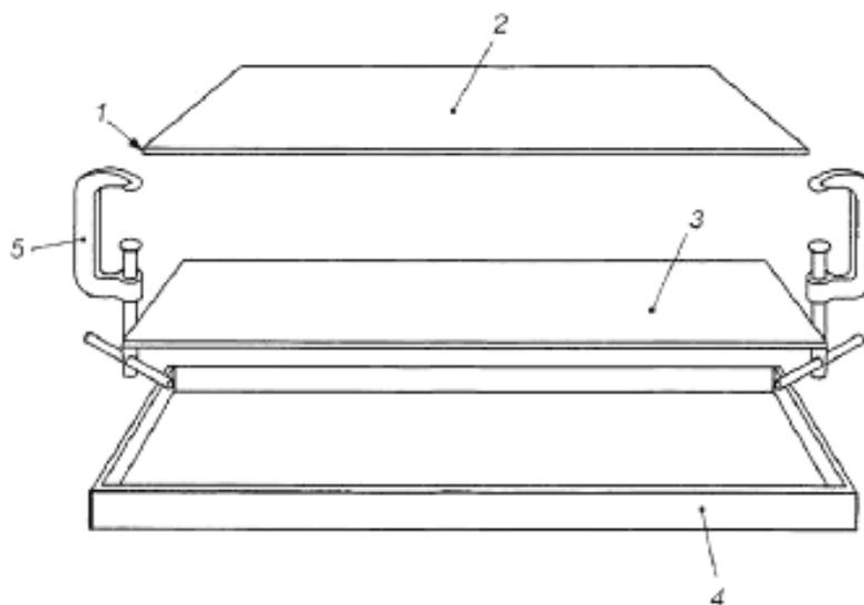
1 – пластинка для испытания; 2 – покрытие; 3 – флотат-стекло; 4 – поддон; 5 – зажим
