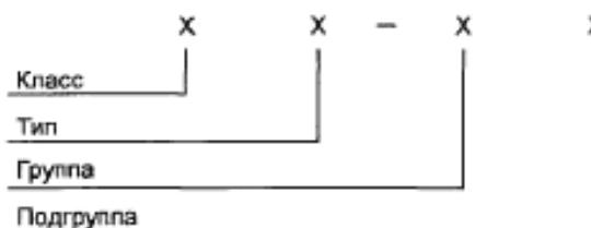
A.2.1 Класс удерживающего бокового ограждения для автомобилей обозначают цифрой 1.
