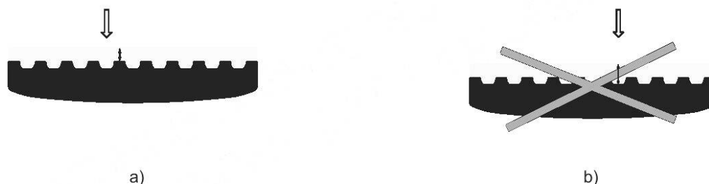
Рисунок С.3 — Измерение мягких пород древесины
