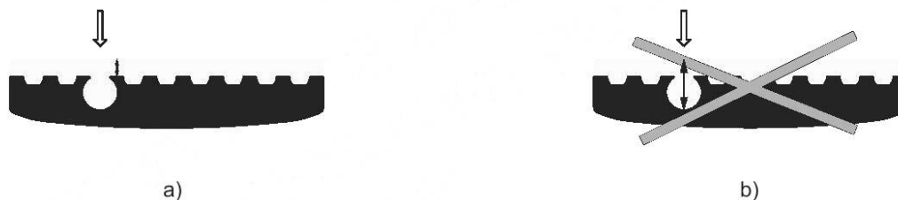
Рисунок С.2 — Измерения на пористых окрашенных поверхностях
