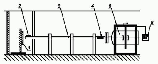
т — объект испытаний; 2 — датчик окорости; 3 — ствол пушки; 4 — ударник; 5 — панель управления; 6 — баллон сжатого воздуха
