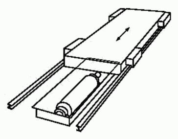
Рисунок С.5 — Приямок с крышкой для высокоскоростного балансировочного станка (класс защиты D, взрывозащищенный)
