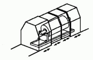
Рисунок С.3 — Телескопический кожух, полностью охватывающий балансировочный станок (класс защиты С)
