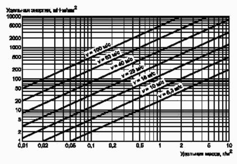
Рисунок А.1 — Зависимость удельной энергии от удельной массы и поступательной скорости движения частицы
