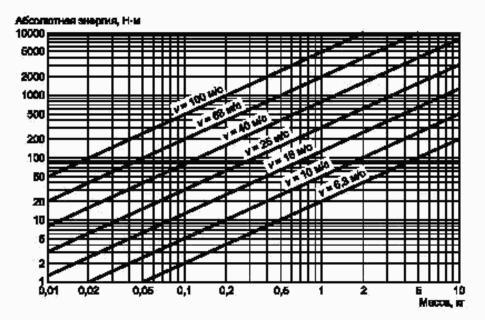
Рисунок A.4 — Зависимость абсолютной энергии от массы и поступательной скорости частицы
