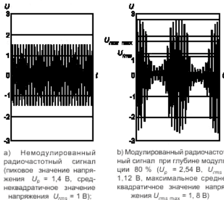
Рисунок 1 – Определение степени жесткости испытаний и формы колебаний на выходе генератора сигналов
