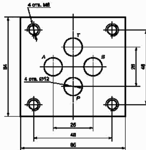
Рисунок А.2 — Присоединительные размеры стыковых плоскостей для четырехлинейных дросселирующих гидрораспределителей с сервоуправлением с максимальным диаметром отверстия 12 мм
