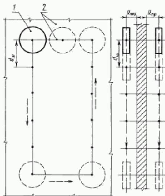
1 — рамочная антенна; 2 — полотно дверного проема
