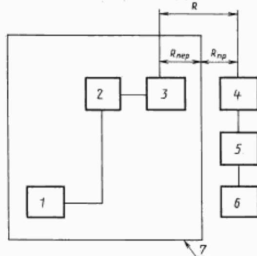
1 — генератор; 2 — аттенюатор; 3 — передающая антенна; 4 — приемная антенна; 5 — аттенюатор; 6 — измерительный приемник; 7 — ЭК
